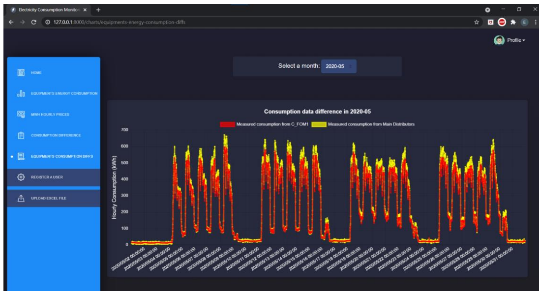
24. ábra: A termelő vállalaton belüli villamos főmérő és főelosztók által mért energiafelhasználás összehasonlítása diagramon.
